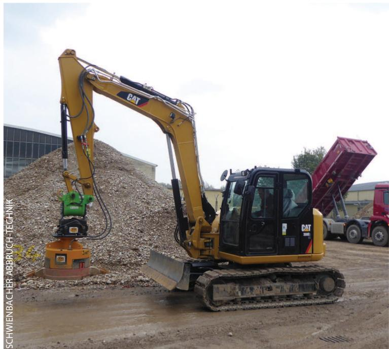
Sorgt für Sicherheit und Ordnung auf der Baustelle. Mit dem Hydraulikmagnet vom Typ HM 5/14 AZ wurde der Bodenaushub auf Munitionsreste und andere metallische Gegenstände untersucht.
